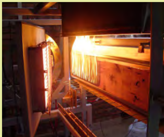
دستگاه آزمون پیشروی سطحی شعله (Flame Spread)
