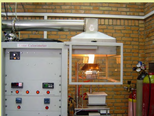
دستگاه آزمون گرماسنج مخروطی
